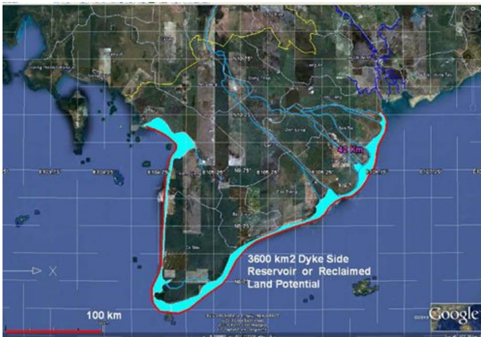
Hình 3: 3,600 km 2 bên trong con Đề Biên Đa Dụng MSD có tiềm năng là những hồ chứa nước và cả tạo thêm vùng đất mới [Ref. 3]
